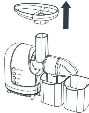
3. Drücke den schwarzen Knopf am Motorgehäuse, drehe das **9. Entsaftungsgehäuse** inkl. Pressschnecke und Trester-Auslass nach rechts und ziehe es nach vorne ab.
